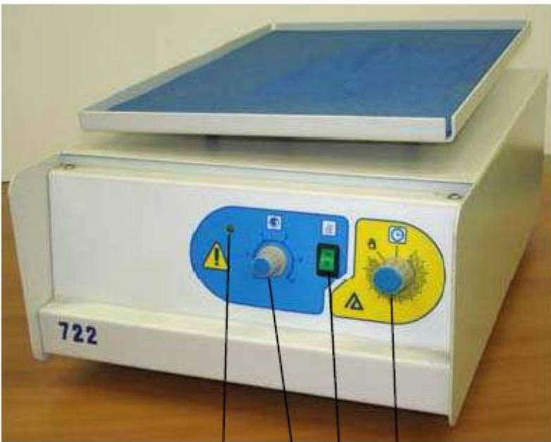
1 Signal lamp for stirrer in function/*Lampe de signalisation pour agitateur en fonction*
